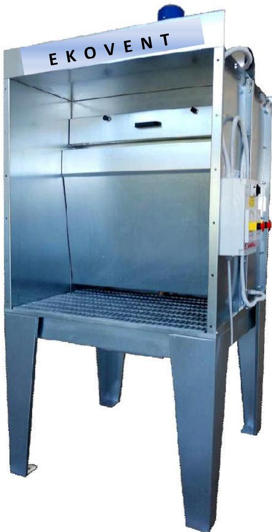
Ova vrsta kabina za lakiranje je pogodna za odsisavanje isparenja boja na sintetičkoj i vodenoj bazi, posebno prilagođena za lakiranje sitnih dijelova. Filtriranje isparenja (overspreja) se vrši preko prednje vodene zavjese, odvajanje ostatka vodenih kapi se vrši kroz pregrade te preko „paint-stop“ filterskih ladica. Kabina je sastavljena od metalnih panela koji su napravljeni od kvalitetnog pocinčanog lima.
